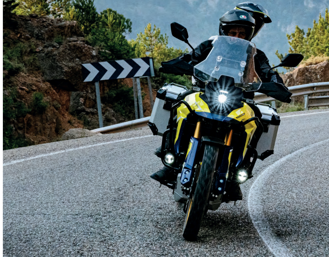
Turistický veterný štít 94600-25820-000 Voľiteľný turistický veterný štít ponúka výrazne vyššiu úroveň ochrany pred vetrom a zvyšuje komfort počas dlhej jazdy (štít je vyšší o 80 mm v porovnaní so štandardným veterným štítom).
