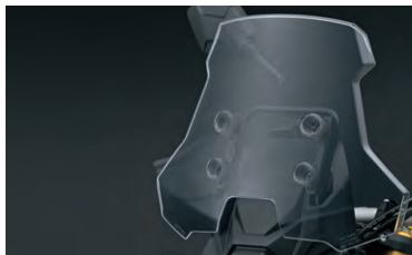
Turistický veterný štít 94600-25820-000 Voľiteľný turistický veterný štít ponúka výrazne vyššiu úroveň ochrany pred vetrom a zvyšuje komfort počas dlhej jazdy (štít je vyšší o 80 mm v porovnaní so štandardným veterným štítom).
