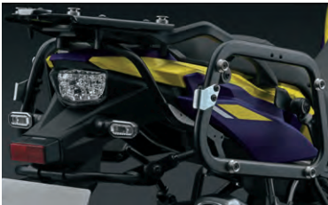
Držiaky bočných kufrů 93700-25820-000 Používajú sa na inštaláciu sady bočných hliníkových kufrů (č. dielu 95400-25840-000 / 95400-25870-000).
