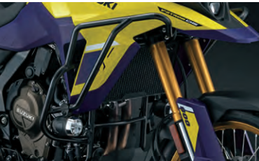
Padáky 94200-25810-000 Dokonalé dopĺňajú farebné odtiene karosérie a motocyklu V-STROM dodávajú unikátny vzhľad „touring“. Vyžaduje sa na inštaláciu hmlových svetiel LED (č. dielu 99172-25100-00 / 99172-25110-000).
