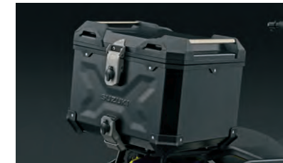
Horný hliníkový kufr (Čierna/38 l) 93100-25860-000 Ideálna voľba v kombinácii s horným hliníkovým kufrom s embosovaným logom SUZUKI. Maximálna nosnosť každého kufra je 3 kg a objem 38 l. Pri používaní tohto výrobku neprekračujte rýchlosť 130 km/h. K dispozícii dve farebné verzie: Elokovaná, Čierna: práškovo lakovaná. V kombinácii so sadou nosičov (č. dielu 93800-25830-000) a 2 zámkami (č. dielu 95700-25810-000).
