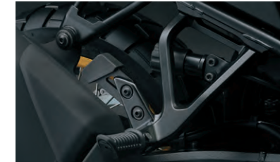
Spodný držiak bočného kufra 93700-25810-000 Vyžaduje sa na inštaláciu sady bočných plastových kufrů (č. dielu 95400-25810-000). V kombinácii s vrchným držiakom bočného kufra (č. dielu 47500-25810-000).
