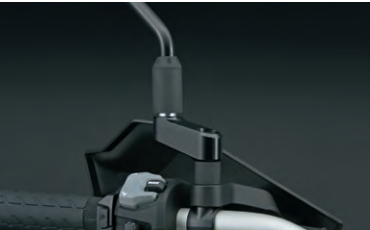
Predĺženie spätného zrkadla 56700-25820-000 Zrkadlo je možné zvýšiť o 50 mm v porovnaní so štandardným nastavením a vysunúť smerom von až o 40 mm, aby jazdcovi prinášalo nový uhol pohľadu za motocykel. Na inštaláciu sa používa sada vymedzovacích podložiek (č. dielu 56000-25810-000). Sada vymedzovacích podložiek pre predĺženie spätného zrkadla 56000-25810-000 V kombinácii s predĺžením spätného zrkadla (č. dielu 56700-25820-000).
