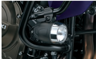
Hmlové svetlo LED 99172-25100-000 Jasné hmlové svetlo LED sú pevne uchytene k padákmi a sú dlhodobo obľúbeným príslušenstvom k modelu V-STROM. Zvyšujú viditeľnosť a zdokonaľujú vzhľad motocykla. Sada pravého a ľavého svetla. V kombinácii s padákmi (č. dielu 94200-25810-000).
