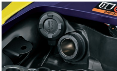
Vtičnica DC (enosmerni tok) 38800-31810-000 Strankam zagotavlja možnost uporabe električnih naprav. Za namestitvev pod sedež.
