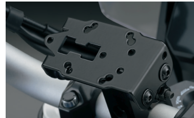
Konzola navigácie 99155-00A00-000 Konzola navigácie so systémom tlmíča nainštalovaná v strede riadiel.
