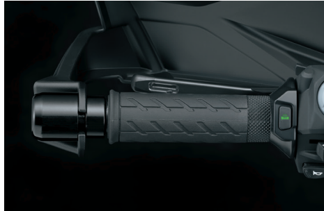
Vyhrievanie rukoväti 57100-48822-000 S tromi rôznymi nastaveniami teploty. Celý povrch je vyhrievaný.
