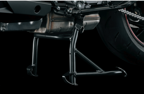
Centrálny stojan 42100-48830-000 Služí na odstavenie motocykla do bezpečnej a stabilnej vertikálnej polohy počas výkonu činností údržby a parkovania.
