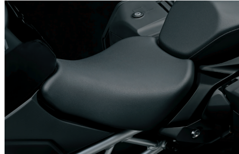
Znížené sedadlo 45100-48K10-88Q Sedadlo znížené o 15 mm v porovnaní so štandardným sedadlom.
