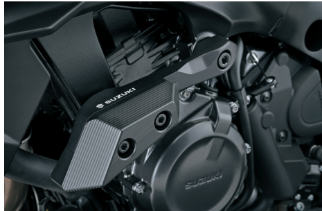
Padací rám 41900-48810-000 Pomáha znižovať škody, vyrobená z hliníka a POM (polyacetal).
