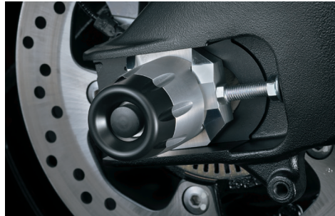
Ochranná matica zadného kolesa 64790-48810-000 Pomáha znižovať škody, vyrobená z hliníka a POM (polyacetal).
