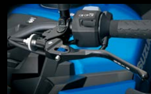
Vyklenutá brzdová páčka (Anodizovaná) Tieto čierne eloxované páčky, ktoré sú opracované zo špičkového hliníkového výrezu a ozdobené logom GSX-S, vylepšia športový vzhľad motocykla.
