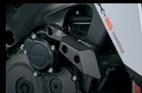
Padací rám Pomáha znížiť poškodenie, je vyrobený z hliníka a ertacetalu.
