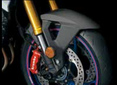
Karbónový predný blatník 99130-48K00-CRB Náhrada OE/matná povrchová úprava. *Nedostupné pre americký/kanadský trh.
