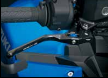
Brzdová páčka (eloxovaná) 99150-48K00-000 Tieto čierne eloxované páčky vyrobené z hliníka zvyšujú športový výzor.
