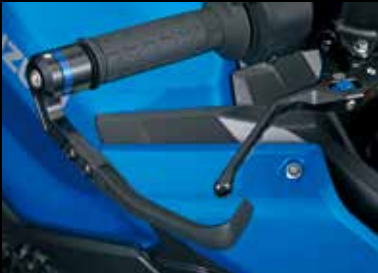
Kryt brzdovej páčky 99152-48K00-000 Vyrobené z vysoko kvalitného hliníkového bloku a odolného plastu.
