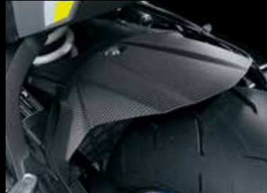
Karbónový zadný blatník 990D0-04K80-CRB Náhrada OE/matná povrchová úprava. *Nedostupné pre americký/kanadský trh.
